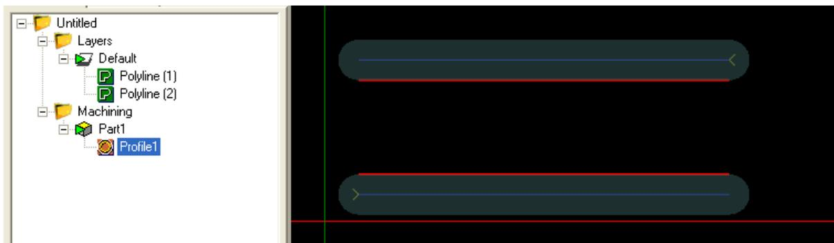
La ligne du bas a été tracée de gauche à droite, celle du haut de droite à gauche. On constate que l'usinage ne se fait pas du même côté de la ligne. La fonction reverse permet de régler le problème sans avoir à appliquer une opération d'usinage différente à chaque ligne (en jouant sur le paramètre intérieur/extérieur).
