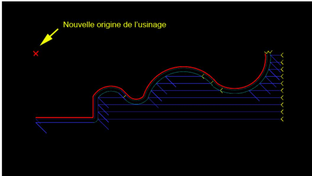
Vous pouvez positionner l'origine de l'usinage par le paramètre **Origine usinage** du dossier *Usinage* ou du dossier *Groupe parent*. Cliquez sur le bouton
