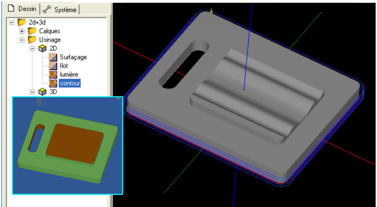
Et usinage avec la fonction de [Profilage 3D](#) basée quant à elle sur l'objet 3D, mais utilisant le contour 2D du rectangle intérieur pour limiter la zone d'usinage 3D à la zone comprise dans la forme (section "limites" des paramètres de la fonction de Profilage 3D. ( voir le [tutoriel 3D](#) pour plus d'informations sur l'utilisation de cette opération d'usinage)
