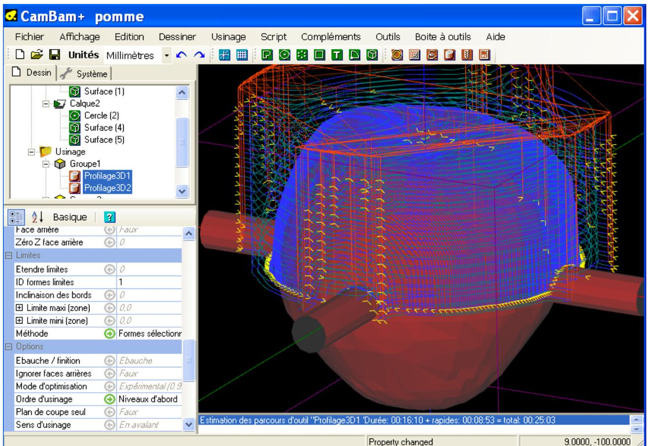
Les parcours d'outil des deux opérations d'usinage de la face avant avec les attaches créées manuellement.
