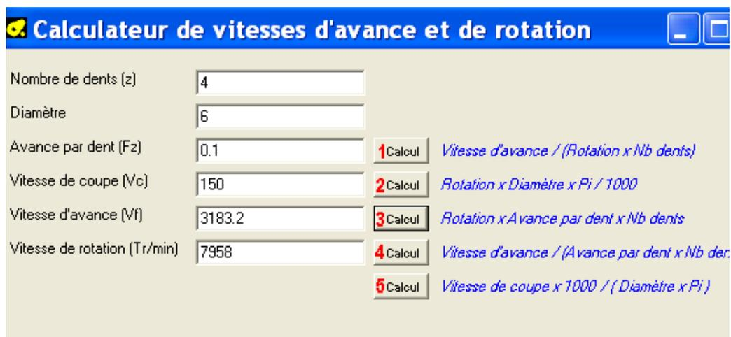
Le calcul fournit une vitesse de rotation de **7958 tr/min** et une avance de **3183.2 mm/min**.
