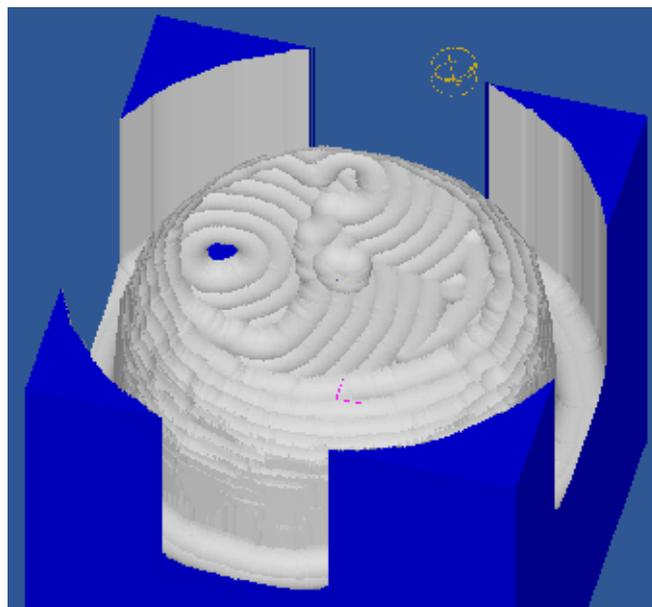
Le résultat final de la passe d'ébauche simulé avec *CutViewer Mill*
