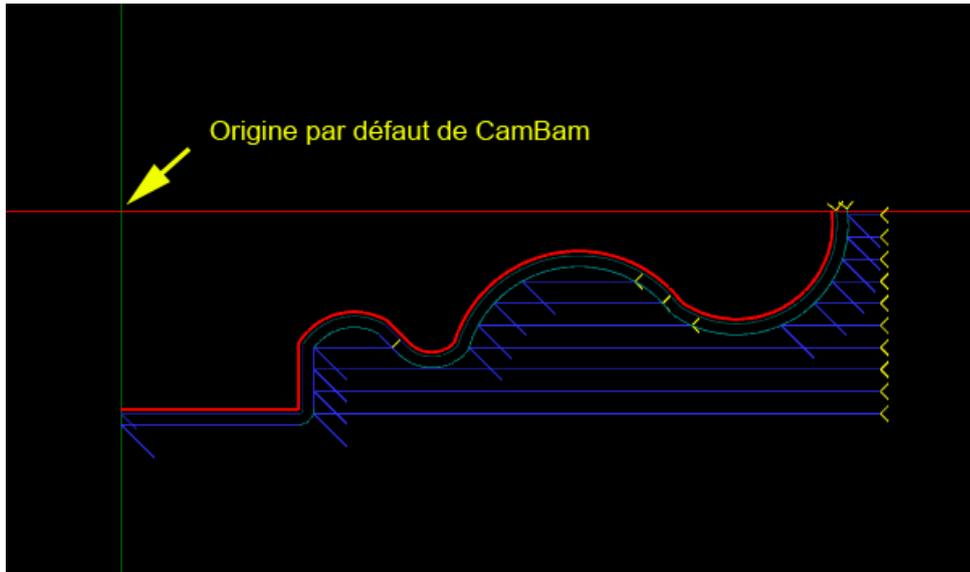
Le même profil dessiné loin de l'origine, l'origine de l'usinage (croix rouge) à été positionnée au point 0,0 des axes X et Z du tour (X et Y de la vue CamBam)
