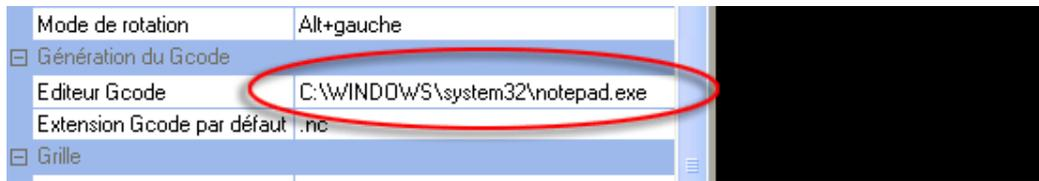
**Objets Fichier Gcode** : (importation de Gcode): Vous pouvez visualiser/éditer le Gcode d'un objet NC File en double cliquant sur l'icône de l'objet dans l'arborescence des opérations d'usinage. Voir le chapitre [Tracé inverse](#) pour plus d'informations.
