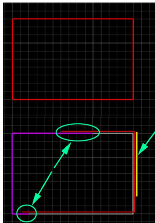
**NOTE:** Dans la dernière version de CamBam, les routines de génération des parcours d'outil tenterons automatiquement de détecter tout "retour en arrière" de la polygone avant de créer les lignes décalées. Dans la plupart des cas l'opération de suppression manuelle des recouvrements n'est plus nécessaire. Ce test automatique peut être désactivé en mettant l'option **Vérification suppl. des trajectoires** à **Faux**
