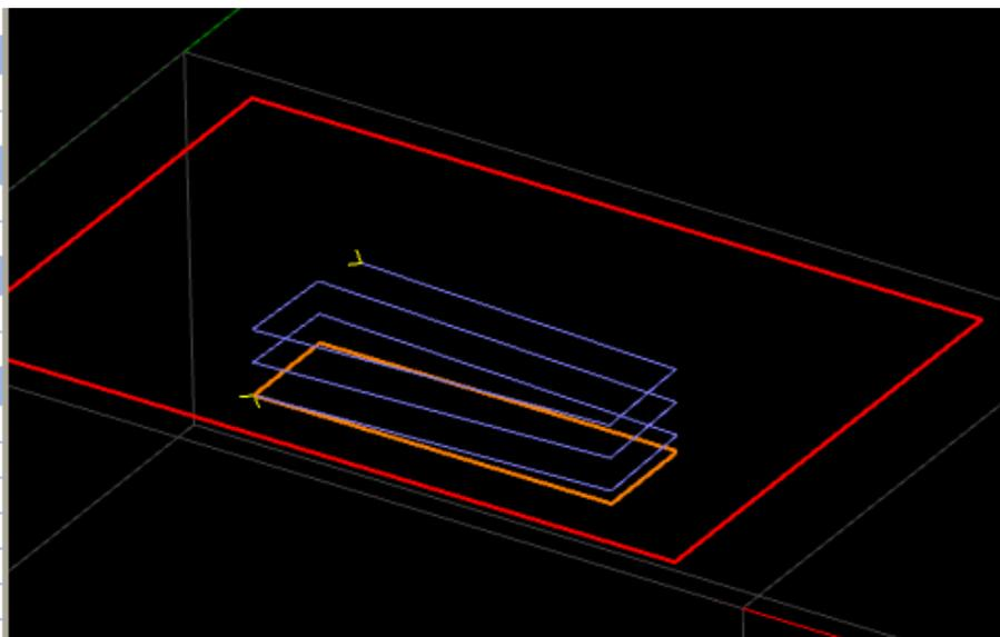
Le paramètre **Vitesse d'avance** permet quant à lui de définir la vitesse d'avance utilisée pour le parcours d'entrée/sortie dans la matière. Le paramètre **Rayon tangent** n'est pas utilisé pour le type Spirale.
