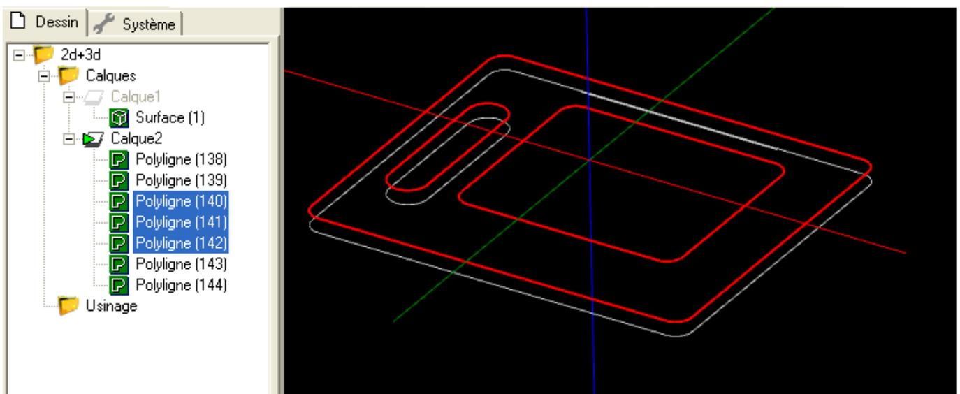
On peut voir sur l'image suivante l'usinage de l'îlot basé sur les deux contours rectangulaires qui ont été extrait, avec le résultat d'une simulation sous *CutViewer* en médaillon.
