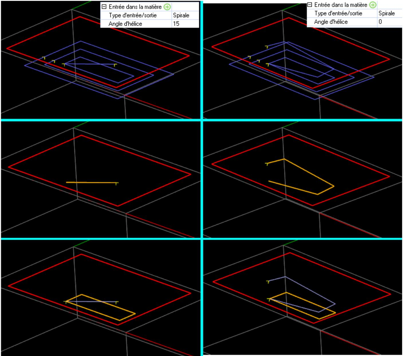
Ici, **Angle d'hélice** à été réglé à 2°, ce qui nécessite plusieurs tours pour atteindre le niveau d'usinage tout en respectant l'angle.
