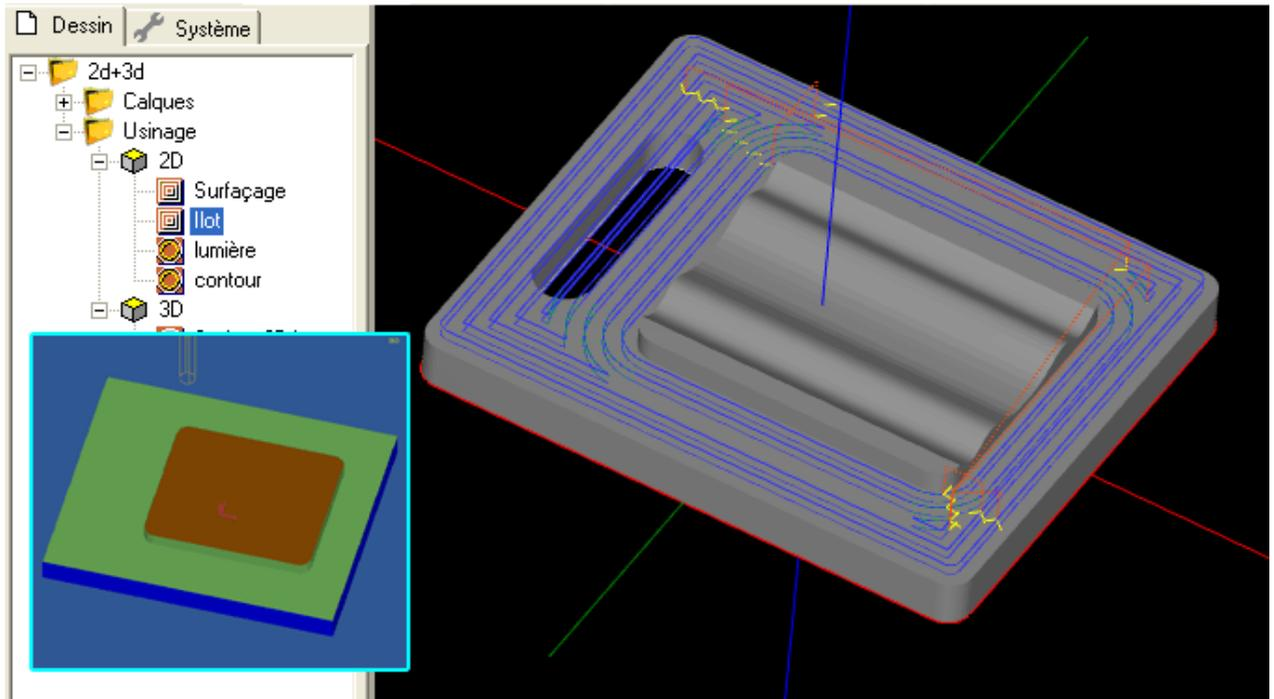
Après finition des usinages basés sur les contours 2D
